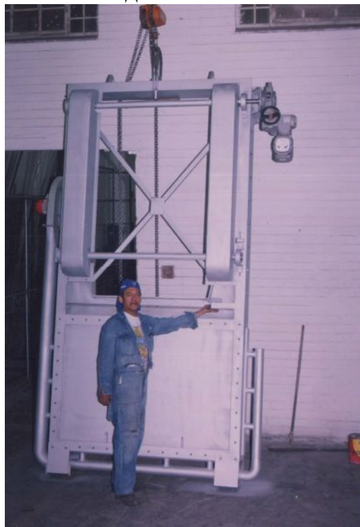
Гильотинная задвижка с газовым уплотнением
