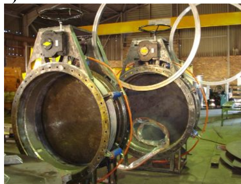
Задвижки очковые механические Ду 1500 мм, с гидравлическими цилиндрами сжатия/разжатия. Шибер - поворотный
