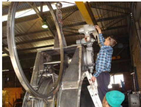
Задвижка очковая с поворотом шиберов от электропривода
