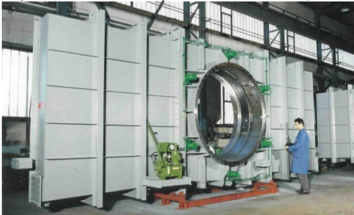
Задвижка очковая, Ду2200, с гидравлическим разжимом, линейным перемещением шиберов и защитным кожухом
