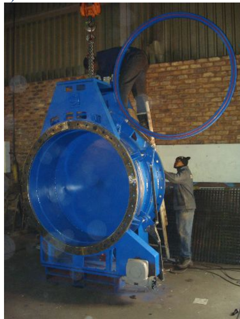
Задвижка очковая механическая Ду 1600 мм, с механическими цилиндрами сжатия/разжатия. Шибер - поворотный
