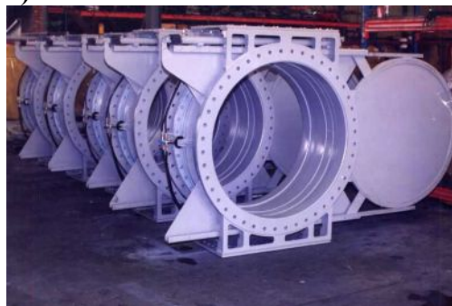
Задвижка очковая Ду500 мм, с линейным перемещением шиберов, разжим внутренних фланцев и перемещение шиберов – от пневматических цилиндров
