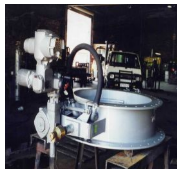
Поворотный затвор с водяным охлаждением корпуса и диска Регулирующий привод AUMA
