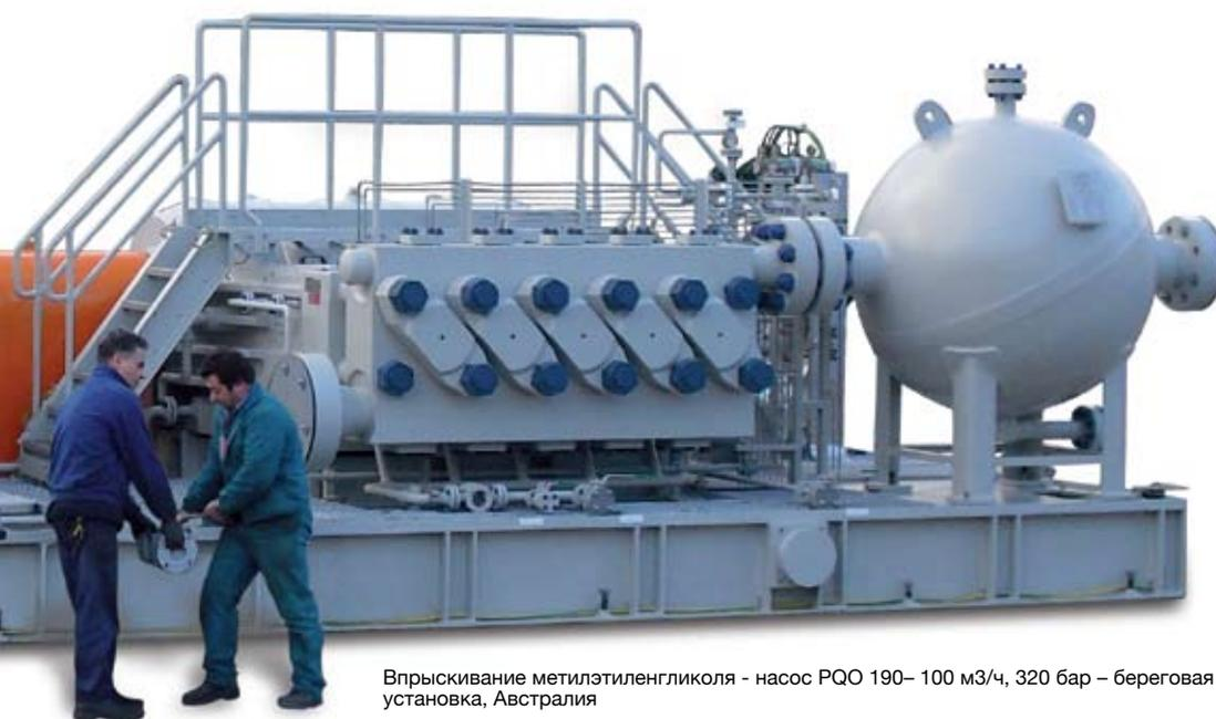
Впрыскивание метилэтиленгликоля - насос PQO 190- 100 м<sup>3</sup>/ч, 320 бар – береговая установка, Австралия
